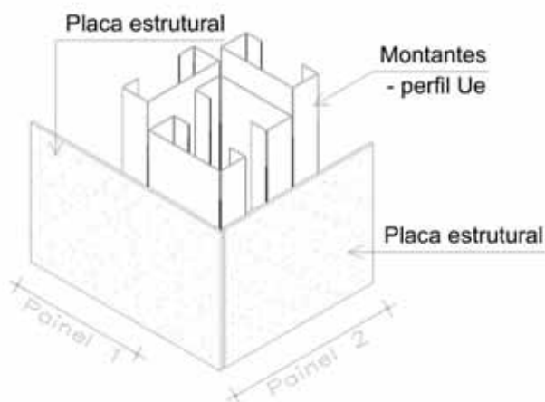
Figura 3.16- Encontro entre duas placas estruturais de canto.
