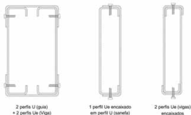
Figura 4.13 - vigas compostas para aumentar a resistência.
