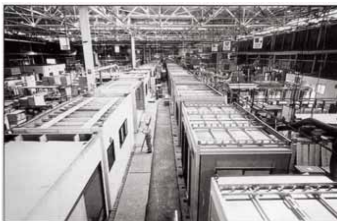
Foto 2.5- Linha de montagem de módulos residenciais no Japão. (Fonte: SCI)
