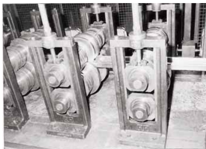
Foto 2.24 - Fabricação por perfilagem de perfis seção Ue. (Fonte: SCI)
