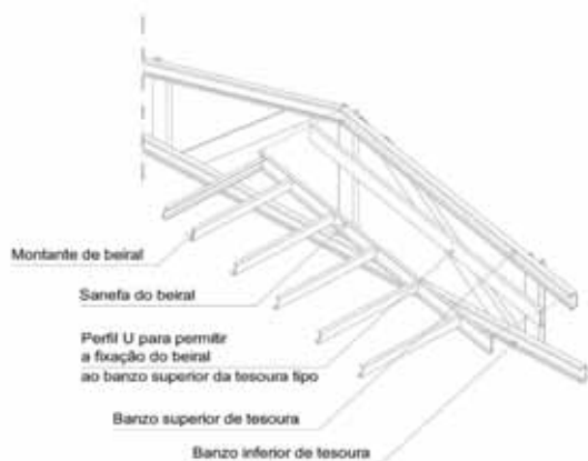
Figura 5.21 - Detalhe de fixação de painel de beiral.
