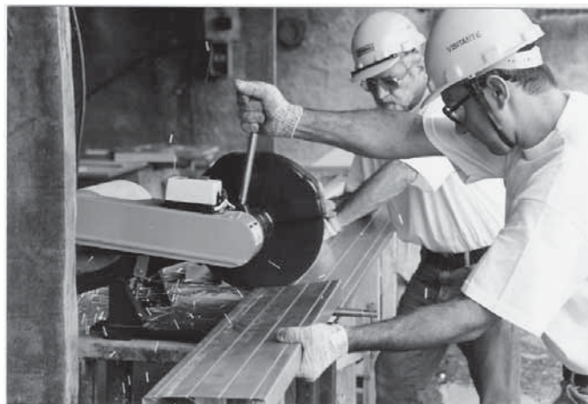
Foto 7.3 – Corte dos perfis com serra circular. (Fonte:arquivo do autor)
